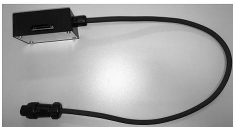
図 17 文字変更用 SD ソケット (ASCO-EHSDS-SOA)
